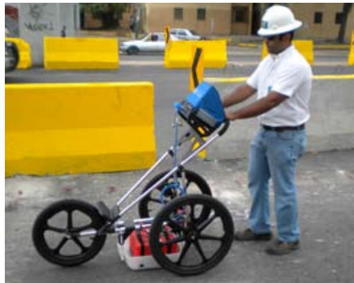
Personal de NDT Systems mientras realiza un estudio de ubicación de tuberías y cableado subterráneo.
